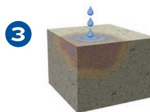
3 La tecnología cristalina se activa con la presencia de humedad.
